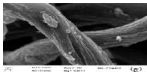
شکل ۱. آنالیز X-ray diffraction (XRD) از جاذب کربن فعال کلاهیک میوه بلوط (قسمت الف) و اصلاح شده با نانوذرات مگنتیک (قسمت ب)، تصویر Scanning electron microscope (SEM) از جاذب کربن فعال کلاهیک میوه بلوط (قسمت ج) و اصلاح شده با نانوذرات مگنتیک (قسمت د)
