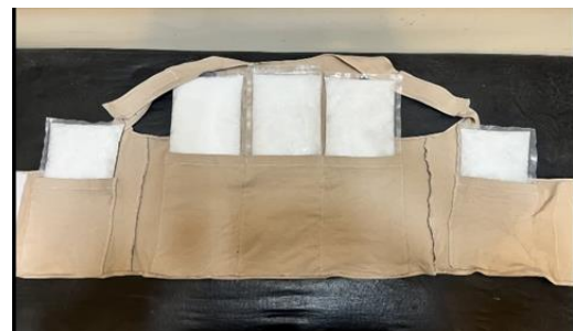
شکل ۱. نمایی از جلیقه خنک‌کننده سدیم سولفات ده آبه
