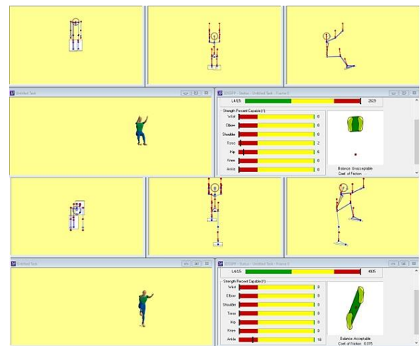
شکل ۱. ارزیابی نیروهای وارد بر بدن در حین مراحل مختلف بالا رفتن از پله‌ها با استفاده از نرم‌افزار 3DSSPP
