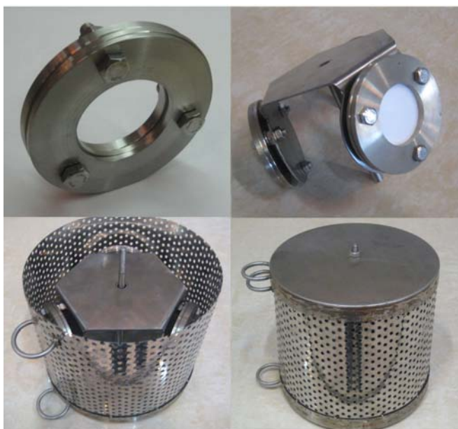
شکل ۴: نمونه بردارهای استفاده شده و محفظه استیل آنها (۲۲)
