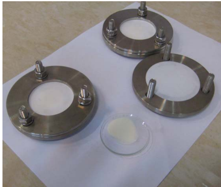
شکل ۳: نمونه‌ای از دیسک‌های POCIS مورد استفاده در عملیات نمونه‌برداری غیرفعال در این مطالعه
