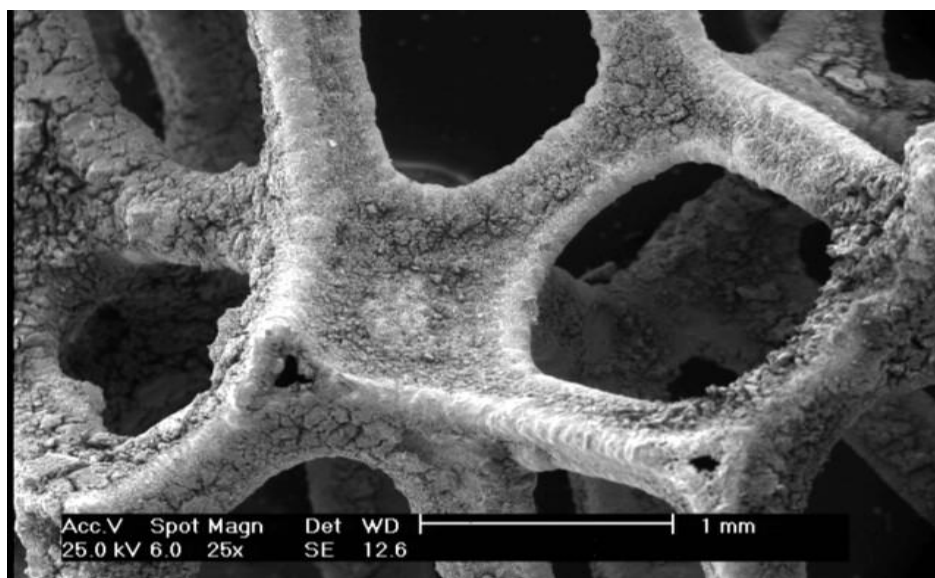
شکل ۱. نمای میکروسکوپ الکترونی روبشی از سطح فوم نیکل پوشش داده شده توسط نانوذرات \text{TiO}_2
