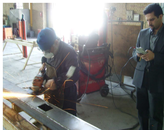
شکل ۲: اندازه‌گیری ارتعاش در حین استفاده کارگر از دستگیره ضد ارتعاش
