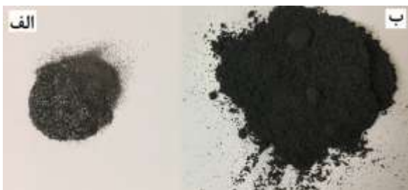
شکل ۱. پودر گرافیت ساده (الف) و گرافیت منبسط شده ورقه ای (ب)
