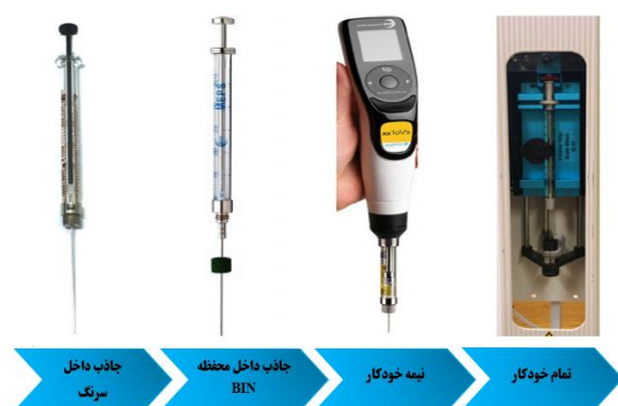
شکل ۳. پیشرفت و توسعه در روش (MEPS) Microextraction by packed sorbent
