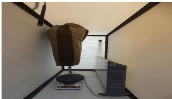
شکل ۲. ارزیابی مشخصات ترموفیزیکی و توان خنک کنندگی شلوارک در محفظه شرایط دمایی و رطوبتی
