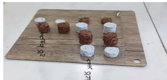
شکل ۱. نمونه‌های ساخته شده از مخروط کاج و خمیر کاغذ باطله
