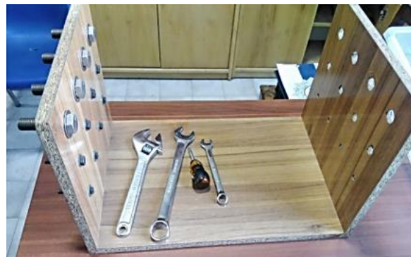
شکل ۱. مجموعه ابزار اندازه‌گیری چابکی کل دست با تست Bennett
