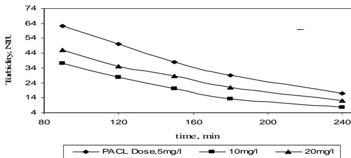
شکل ۳: کدورت خروجی در زمان‌های ماند مختلف با افزودن دوزهای مختلف PACL با کدورت ورودی: الف) ۲۰، ب) ۵۰، ج) ۱۰۰ mg/l
