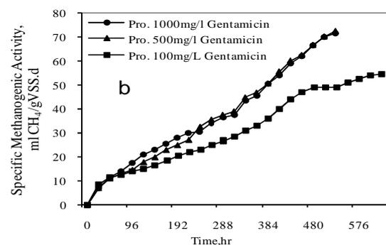
نمودار ۳: تأثیر آنتی‌بیوتیک‌های آمپی‌سیلین و جنتامایسین بر روی میزان تجمعی متان‌سازی ویژه بیومس بی‌هوازی (الف) غلظت‌های متفاوت آمپی‌سیلین بر روی پروپیونیک اسید شامل ۱۰۰۰ (●)، ۵۰۰ (▲) و ۲۰۰ (■) میلی‌گرم در لیتر و (ب) غلظت‌های متفاوت جنتامایسین بر روی پروپیونیک اسید شامل ۱۰۰۰ (●)، ۵۰۰ (▲) و ۱۰۰ (■) میلی‌گرم در لیتر (کلمه اختصار Pro. در نمودارها به معنی پروپیونیک اسید است)
