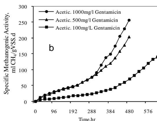
نمودار ۲: تأثیر آنتی‌بیوتیک‌های آمپی‌سیلین و جنتامایسین بر روی میزان تجمعی متان‌سازی ویژه بیومس بی‌هوازی (a): غلظت‌های متفاوت آمپی‌سیلین بر روی استیک اسید شامل ۱۰۰۰ (●)، ۵۰۰ (▲) و ۲۰۰ (■) میلی‌گرم در لیتر و (b) غلظت‌های متفاوت جنتامایسین بر روی استیک اسید شامل ۱۰۰۰ (●)، ۵۰۰ (▲) و ۱۰۰ (■) میلی‌گرم در لیتر. (کلمه اختصار Acetic در نمودارها به معنی استیک اسید است)
