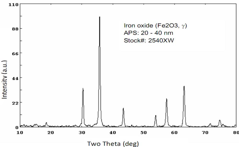
نمودار ۱. میکروگراف XRD- $\text{Fe}_2\text{O}_3$ -استفاده شده در این تحقیق
