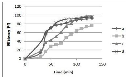
شکل ۸. راندمان حذف کاتالیستی با  $3/9 \text{ w/m}^2$  شدت تابش فرابنفش (a) بستر ثابت  $\text{TiO}_2/\text{Zeolite}$  با غلظت  $10 \text{ mg/L}$ ؛ (b) بستر ثابت  $\text{TiO}_2/\text{Zeolite}$  با غلظت  $50 \text{ mg/L}$ ؛ (c) بستر متحرک  $\text{TiO}_2/\text{Zeolite}$  با غلظت  $10 \text{ mg/L}$ ؛ (d) بستر متحرک  $\text{TiO}_2/\text{Zeolite}$  با غلظت  $50 \text{ mg/L}$
