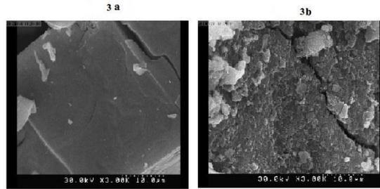
شکل (a) الگوی SEM نانوذرات  $TiO_2$  - شکل (b) الگوی SEM  $TiO_2$ /Zeolite
