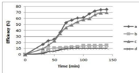
شکل ۴. راندمان حذف فتوکاتالیستی (a)  $TiO_2$ /Zeolite با غلظت ۱۰ mg/L؛ (b)  $TiO_2$  با غلظت ۱۰ mg/L؛ (c)  $TiO_2$ /Zeolite با غلظت ۵۰ mg/L؛ (d)  $TiO_2$  با غلظت ۵۰ mg/L
