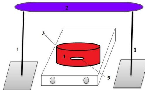
شکل ۱. تصویر شماتیک راکتور در حذف فتوکاتالیستی سافرانین قرمز: (۱) پایه نگهدارنده لامپ UV، (۲) لامپ UV، (۳) همزن مغناطیسی، (۴) ظرف حاوی فتوکاتالیست و رنگ، (۵) مگنت
