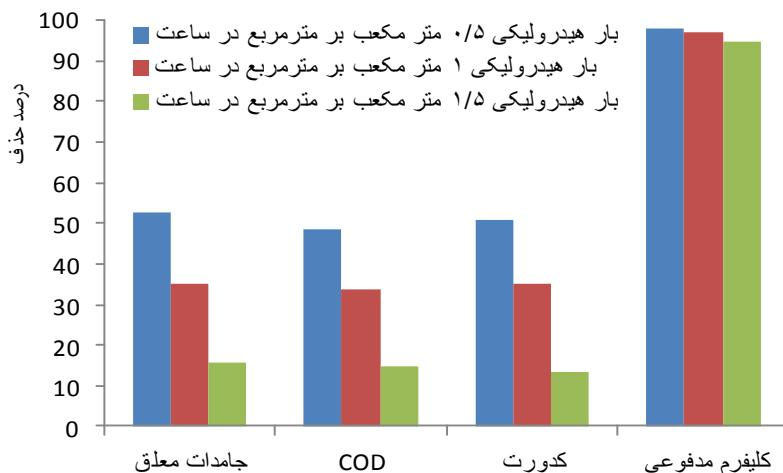
شکل ۲. راندمان فیلتر دانه درشت با جریان افقی در کاهش COD، جامدات معلق، کدورت و کلیفرم مذکووعی از پساب زلالساز لاغون‌های با هوادهی بوکان
