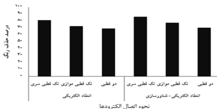
نمودار ۷. تأثیر نحوه اتصال الکترودها در کارایی فرایندهای انعقاد الکتریکی - شناورسازی در شرایط بهینه بهره‌برداری
