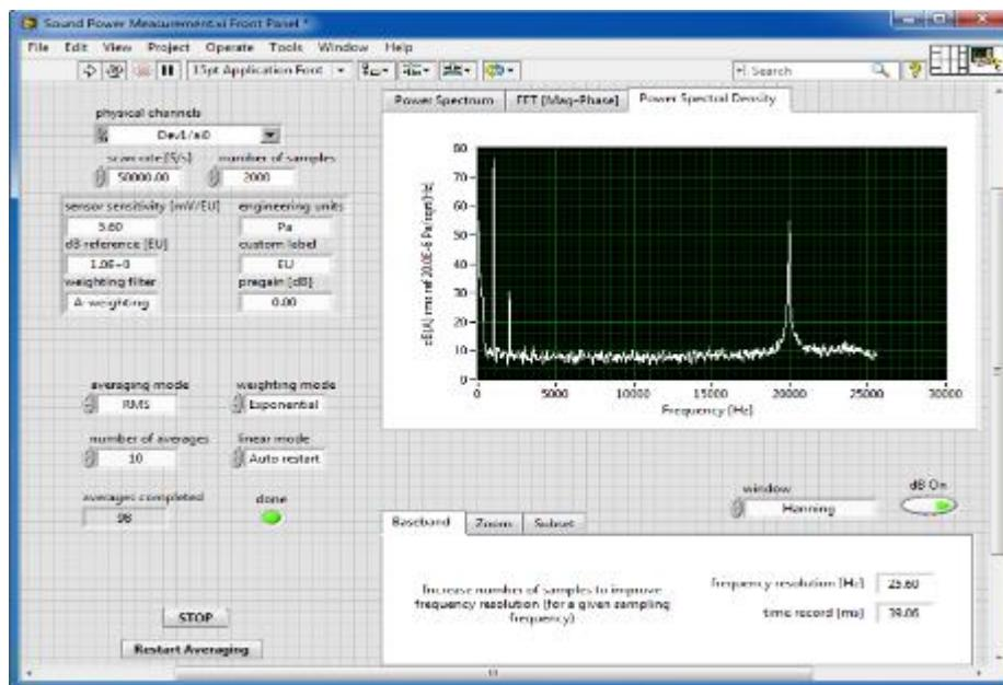
شکل ۱۱. نتایج اندازه‌گیری تراکم طیف توان صوت
