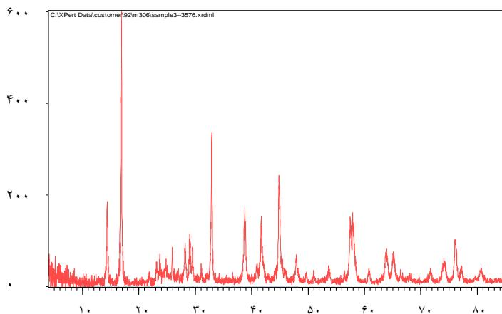
شکل ۱. طیف X-Ray diffraction (XRD) حاصل از سنگ معدن بوکسیت مندون
