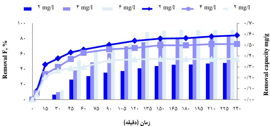
شکل ۲. اثر زمان تماس روی ظرفیت جذب فلوراید (5g بوكسیت، pH = ۷، غلظت فلوراید ۲، ۴، ۶ mg/l و ۲، ۴، ۶ mg/l)
