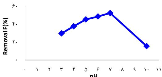
شکل ۳. اثر pH روی راندمان حذف فلوراید (مقدار بوکسیت ۵ g، غلظت اولیه فلوراید ۲ mg/l)
