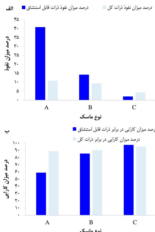
شکل ۲. درصد میزان نفوذ (الف) و کارایی (ب) سه نوع ماسک A، B و C در برابر ذرات قابل استنشاق و ذرات کل
