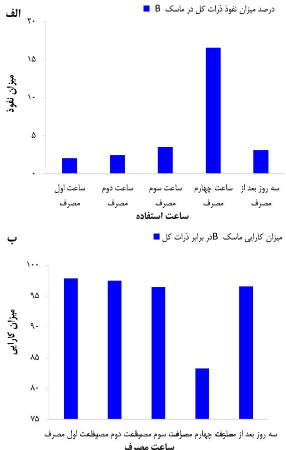
شکل ۴. درصد میزان نفوذ ذرات کل در ماسک نوع B (الف) و درصد میزان کارایی ماسک نوع B در برابر ذرات کل (ب) بر حسب زمان مصرف
