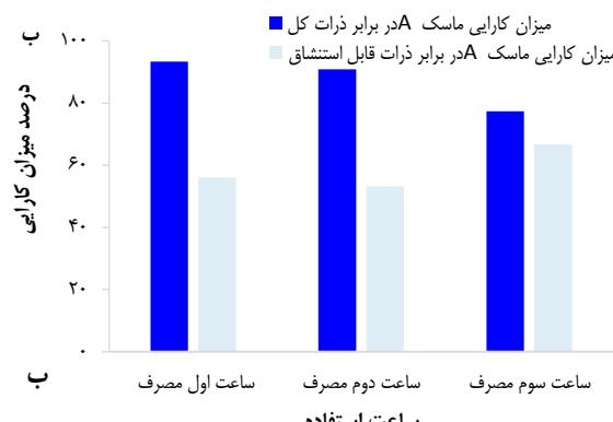
شکل ۲. درصد میزان نفوذ ذرات قابل استنشاق و کل در ماسک نوع A (الف)، درصد میزان کارایی ماسک نوع A در برابر ذرات قابل استنشاق و کل (ب) بر حسب زمان مصرف
