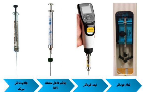
شکل ۳. پیشرفت و توسعه در روش (MEPS) Microextraction by packed sorbent
