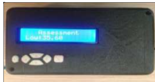
شکل ۴. نمونه‌ای از نتیجه نهایی ارایه شده توسط دستگاه سنجش بار کاری فیزیکی
