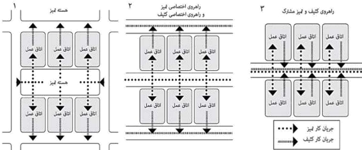
شکل ۲. مجموعه اتاق‌های عمل ۱. با هسته تمیز، ۲. با راهروی اختصاصی و کثیف و تمیز مشترک (۳۲)
