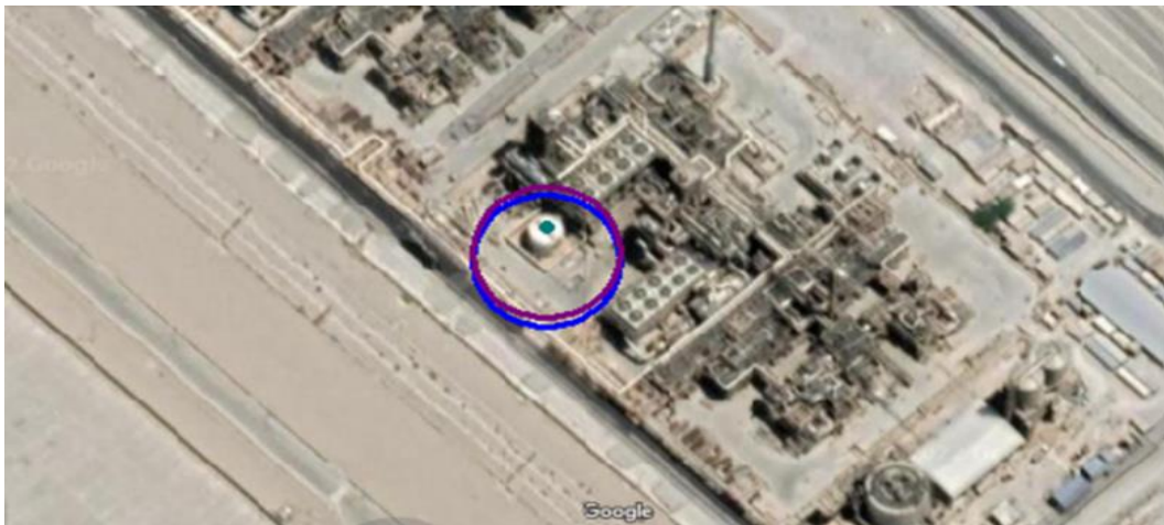
شکل ۲. نمودار Geographic information system (GIS) در حالت ۳۷/۵ کیلووات بر مترمربع تشعشع برای آتش استخری
