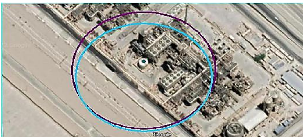
شکل ۳. نمودار Geographic information system (GIS) در حالت ۴ کیلووات بر مترمربع تشعشع برای آتش استخری
