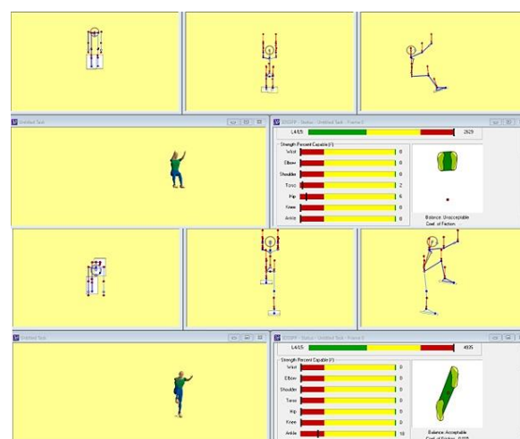
شکل ۱. ارزیابی نیروهای وارد بر بدن در حین مراحل مختلف بالا رفتن از پله‌ها با استفاده از نرم‌افزار 3DSSPP
